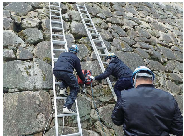
④ 地中レーダー探査 石垣内側にある裏込 うらこめ の状況を確認
